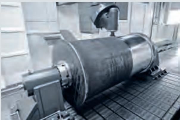
Die Zerspanung der Nuten für die Seilwindungen dieser Seiltrommel konnte dank der DMU 600 P von ein bis zwei Tagen auf drei Stunden reduziert werden.
