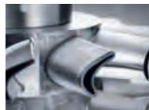
Laserauftragsschweißen und Fräsen von Turbinenschaukeln
