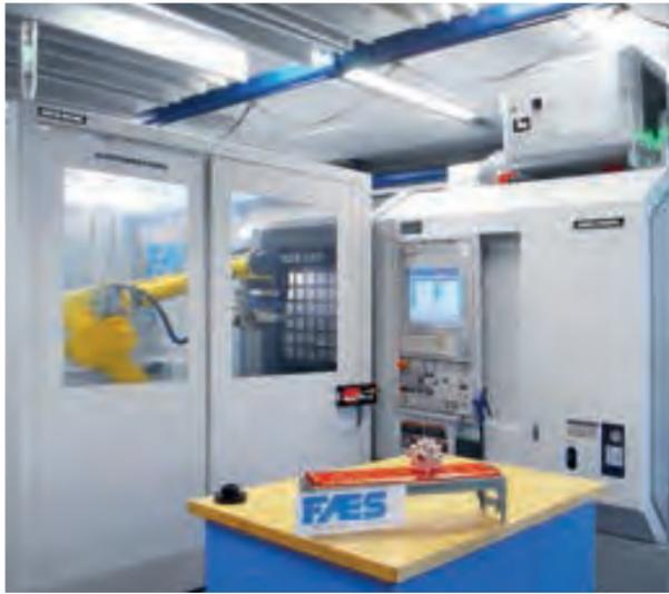
Die Roh- und Fertigteilegreifer des Handlingroboters WH25 sind für Teile mit einem Gewicht von bis zu 25 kg ausgelegt.
