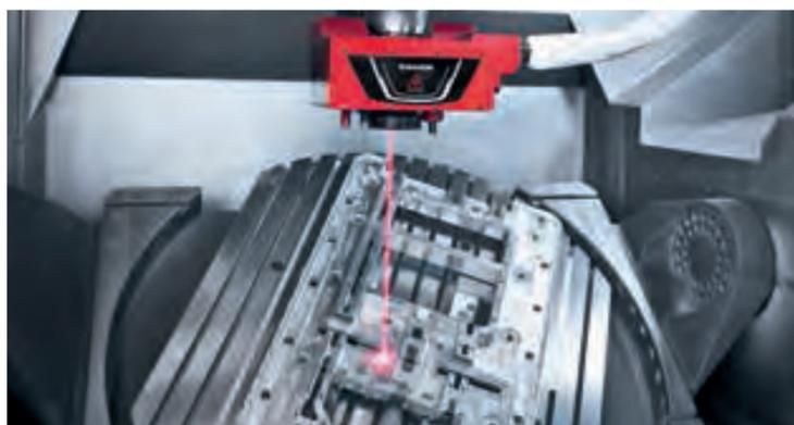
Die Möglichkeit des direkten 5-Achs-Lasertexturierens von Formwerkzeugen auf der LASERTEC 125 Shape ersetzt das sehr aufwendige und nicht-umweltschonende Ätzen.
