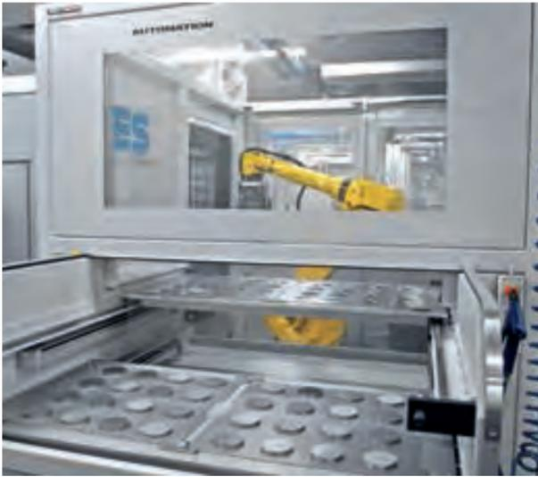
Der integrierte Werkstückspeicher für Teile bis 300 kg je Schubfach gewährleistet eine sichere und effiziente Bereitstellung der Rohlinge.
