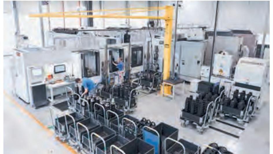
In einer voll automatisierten Fertigungszelle mit fünf NHX 5500 Horizontalbearbeitungszentren bearbeitet Dana Ungarn 16 unterschiedliche Werkstücke auf vier Produktfamilien.
