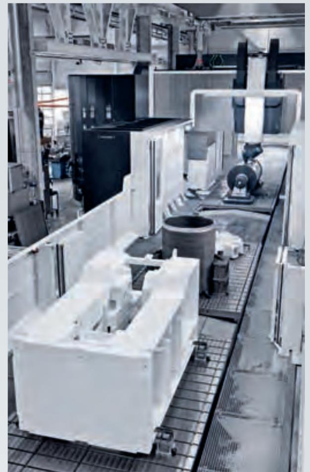
Gekoppelt oder einzeln verfahrbar – auf den drei Tischen kann die maximale Bearbeitungslänge von 18 m ebenso ausgenutzt werden wie alle Vorteile des hauptzeitparallelen Rüstens.
