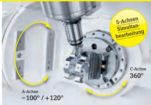
Noch effizienter und flexibler durch optionale integrierte 4. / 5. Achse – ein Eigenbau von DMG MORI (DDR).
