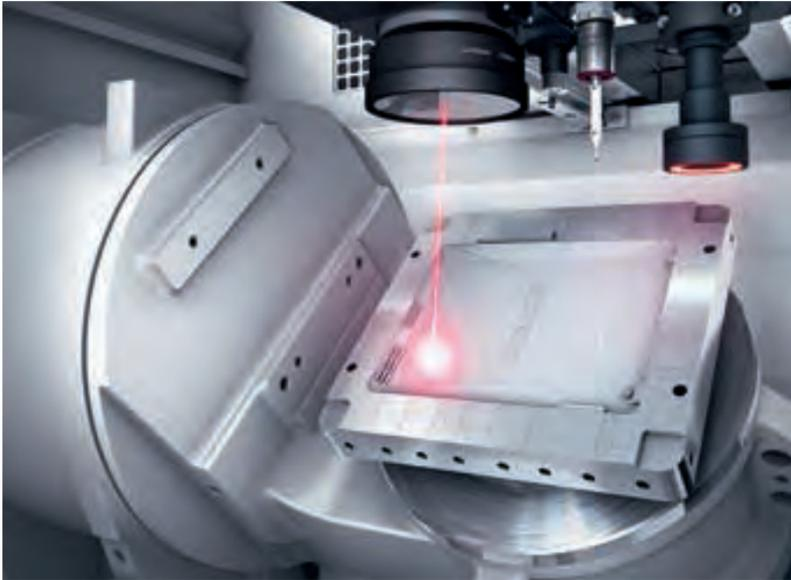
Arbeitsraum der LASERTEC 45 mit integriertem Schwenk- / Rundtisch (5-Achs-Version), Laserkopf mit Präzisionsscanner, CCD-Kamera und ausfahrbarem Messtaster.
