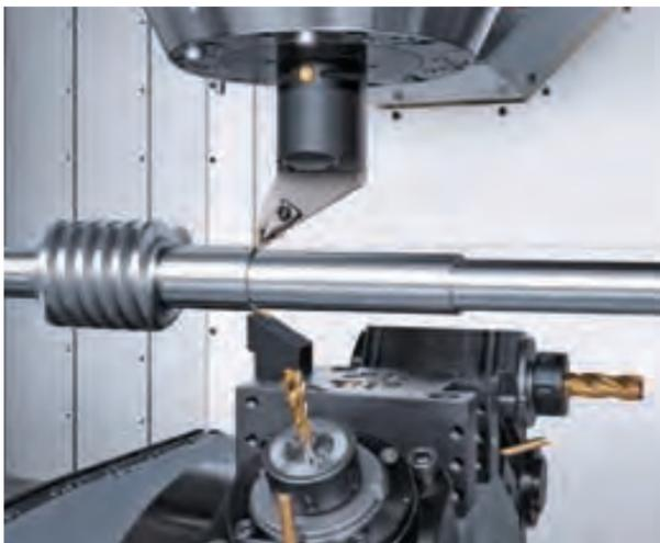
4-Achs-Bearbeitung mit B-Achse und unterem Revolver.
