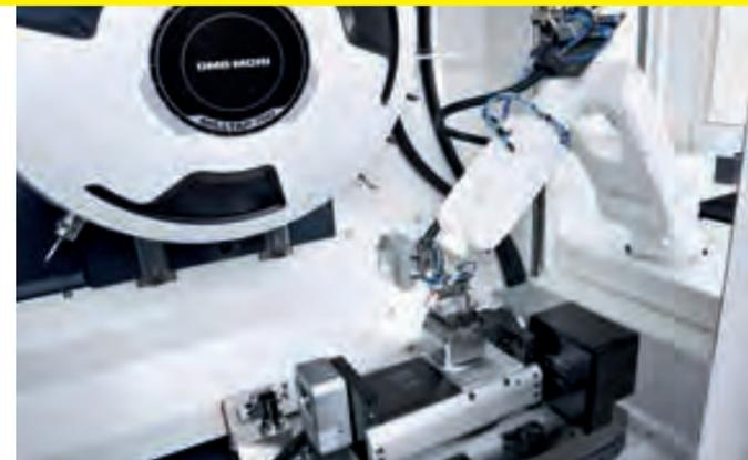
Werkstück Handling WH 2 | WH 3. Hohe Autonomie mit kurzen Taktzeiten, geringe Aufstellfläche, hohe Werkstückspeicherkapazität.
