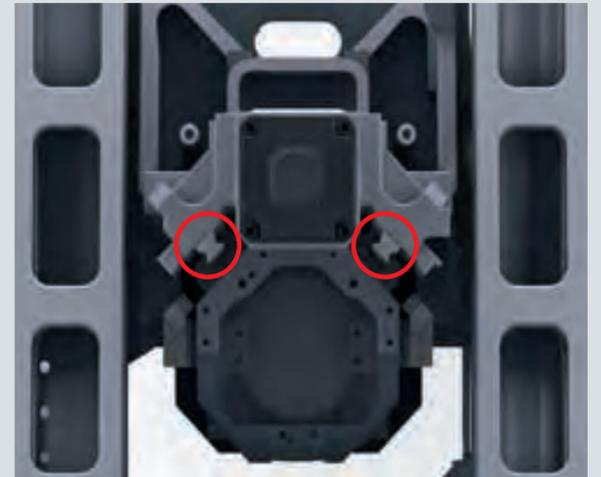
Höchste Stabilität durch zwei angewinkelte Führungen. Führungsbahnen liegen außerhalb des Spänefalls.
