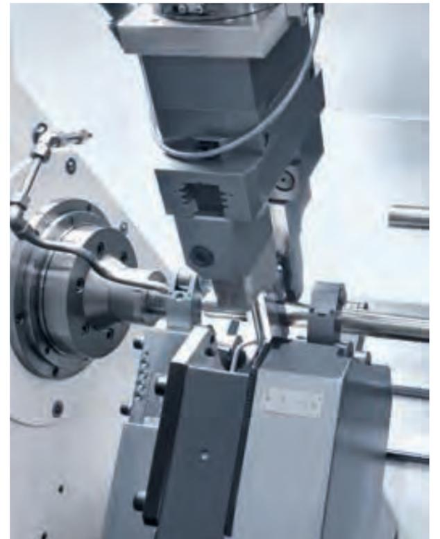
Die Lünette in der CTX beta 800 linear dient der Stabilisierung des Werkstücks, wenn das abschließende Nut- und Bohrungsfräsen erfolgt.
