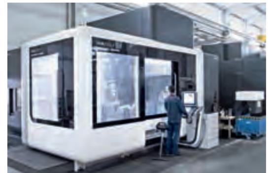
Zu den 20 DMG MORI Bearbeitungszentren, die Müller einsetzt, zählt eine DMU 210 P. Jüngst wurde zudem in eine DMU 270 P investiert.
