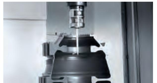
L-Messtasterpakete ermöglichen eine deutliche Erhöhung von Prozesssicherheit und Effizienz durch das Vermessen auch schwer zugänglicher Stellen direkt im Prozess. Neben der Vermessung von Stegen und Nuten, können auch Einzelpunkte und Durchmesser ermittelt werden.
