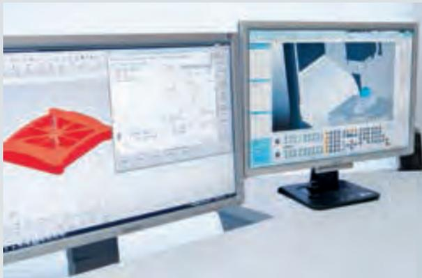
DMG Prozesskette im ZSW: Die zur Fertigung erforderlichen NC Programme werden mit Siemens NX CAM erstellt und direkt am PC mit der DMG Virtual Machine auf ihre Machbarkeit geprüft.
