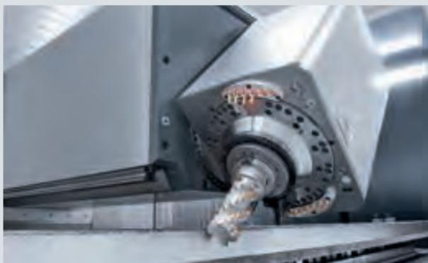
Auch voll ausgefahren – in Y-Richtung sind das 1.100 mm – arbeitet der Fräskopf mit B-Achse vibrationsfrei.
