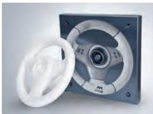
Lenkrad-Schäumwerkzeug aus Aluminium und geschäumtes Muster mit unterschiedlichsten Oberflächenstrukturen (u. a. Waben-, Netzgitter-, Karamuster-Textur).
