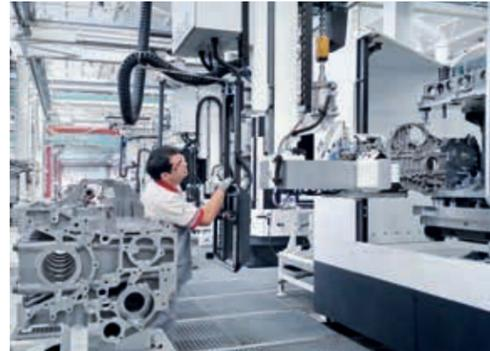
Am Rüstplatz werden die Bauteile beladen.
