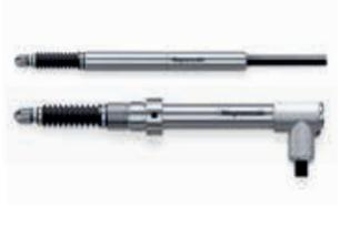
Für Anwendungen in der automatisierten Qualitätskontrolle in Produktions- und Montagelinien. Messbereiche: 5 mm bis 205 mm Genauigkeit: bis zu ±0,5 µm Lebensdauer: bis zu 90 Mio. Hübe
