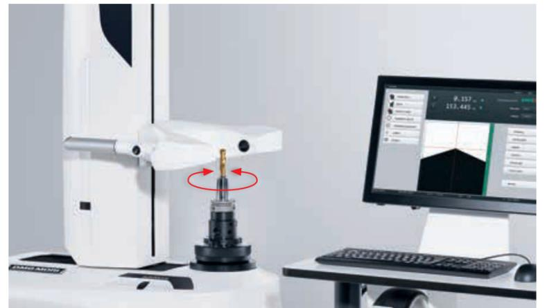
**Zum automatischen Scharfstellen der Schneide.** Motorisch betriebene Spindel, mit Komfort-Systemschrank und 24"-Touch-Display im Standard.
