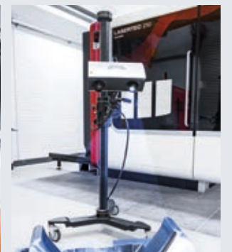
Vermessen der Werkzeuggeometrie mittels 3D-Scanner.
