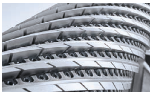
Walzenschälfräser der mit mehreren hundert Messern bestückt ist.
