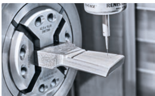
5-Achs-Simultanbearbeitung der Messereinsätze für Walzenschälfräser auf der NTX 1000.
