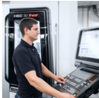
HSC 30 linear – 40.000 min -1 und Linearantriebe sorgen für µ-genaue Fertigungsergebnisse auch in schwer zerspanbaren Werkstoffen, z.B. Wolfram und Kupfer.
