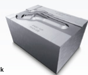
Schmiedegesenk für Hüftnagel Maschine: DMC 650 V Material: 1.2343 Maße: 250 x 200 x 100 mm
