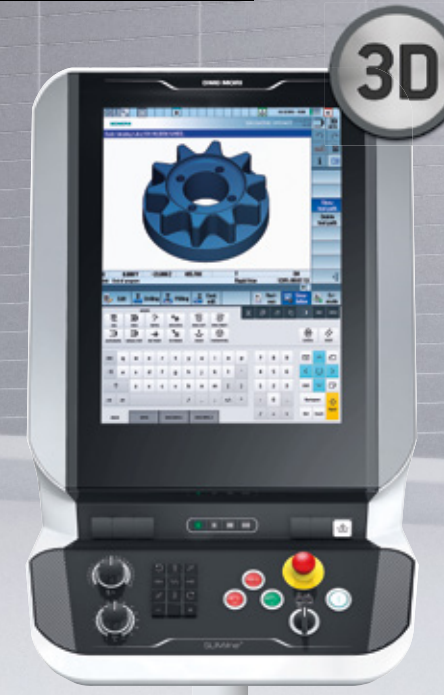
19" DMG MORI SLIMline® Multi-Touch-Steuerung mit Operate 4.7 auf SIEMENS
