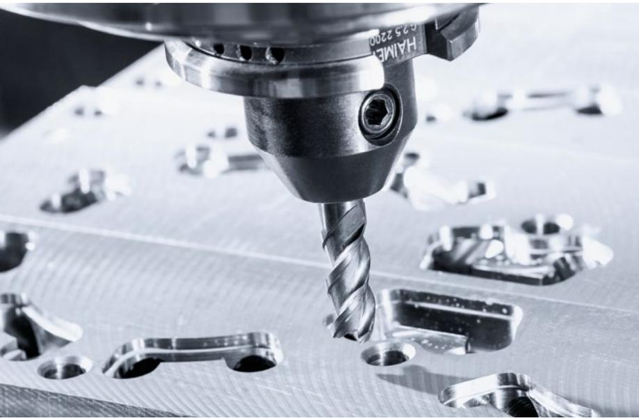
Die Fertigung von Extrusionsblaswerkzeugen reicht vom Bohren und Fräsen der Kühlungen über das Schruppen bis zum Schlichten und stellt damit den Bedarf an universell einsetzbaren Bearbeitungszentren.
