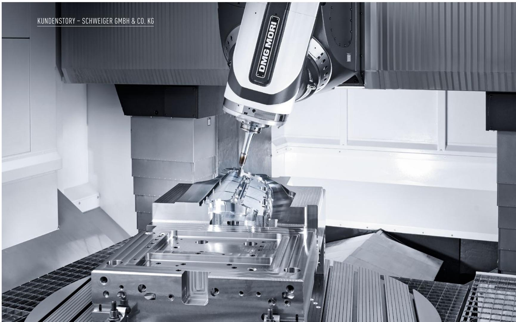
Hochpräzise Formbearbeitung auf einer DMU 210 P.
