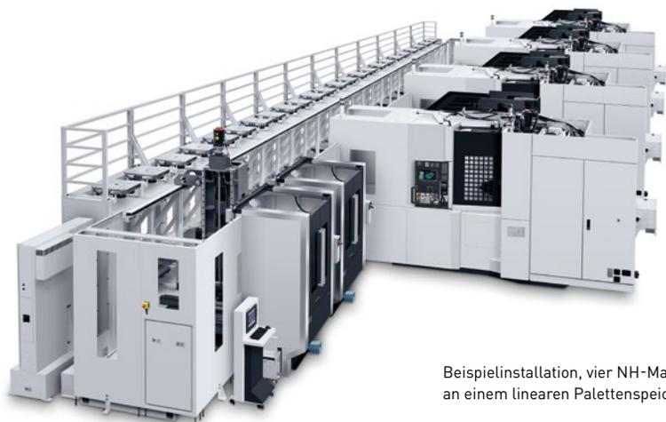
Beispielinstallation, vier NH-Maschinen an einem linearen Palettenspeicher LPP.
