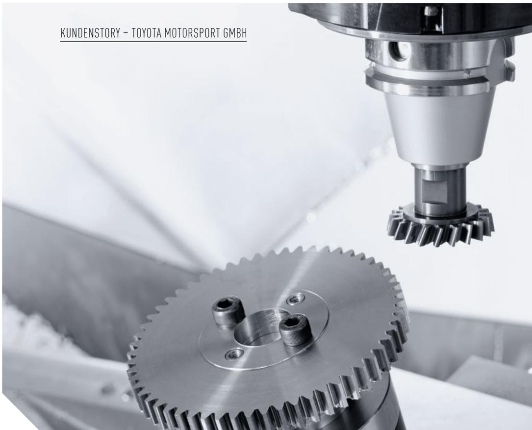
DMG MORI gearSKIVING — Bearbeitung von Zahnradern auf einer DMU 60 eVo in Schleifqualität.
