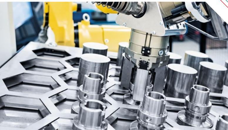
Bei unterschiedlichen Durchmessern berechnet der Robo2Go automatisch den Mittelpunkt der Werkstücke, um diese präzise zu greifen.
