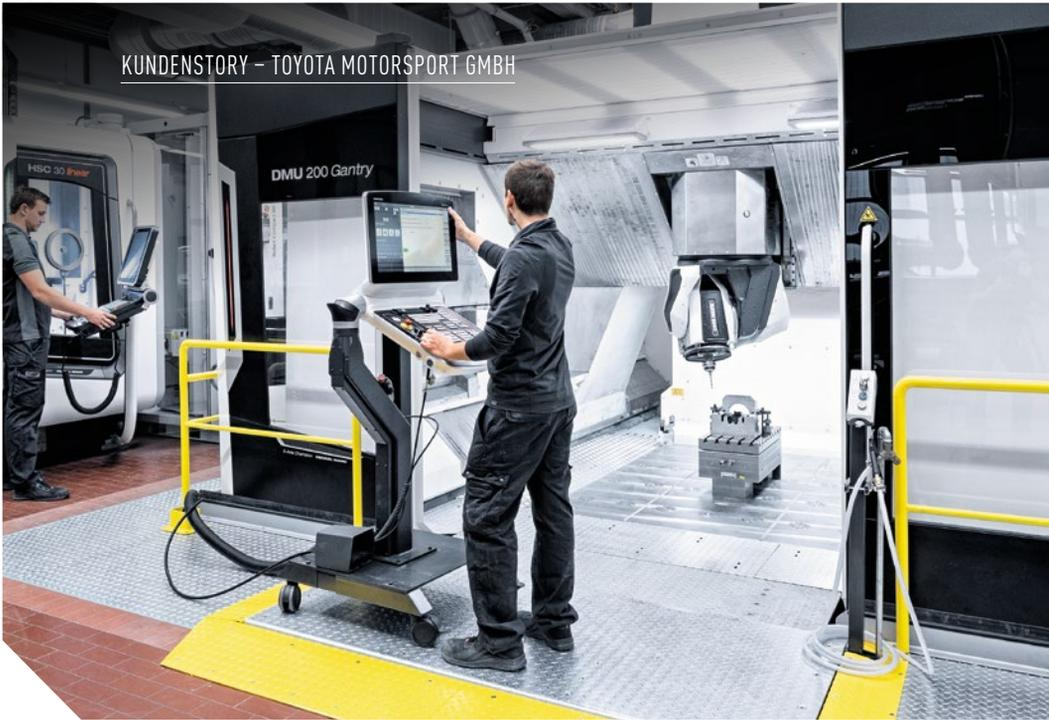
Ebenerdige Aufstellung der DMU 200 Gantry in einer Grube, um die empfindlichen Carbon-Bauteile mit einem Stapler zu be- und entladen.
