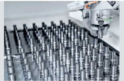
Dank integrierter Automation fertigt M.T. Losgrößen bis 1.500 Teile nahezu mannos.
