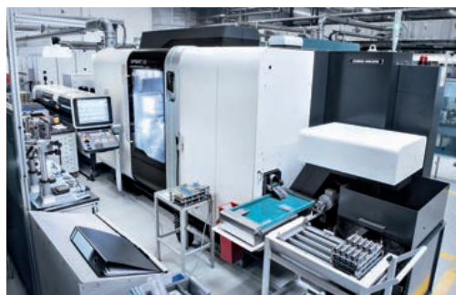
Fertigung auf der SPRINT 65 mit höchster Genauigkeit, z. B. Ebenheit von 0,004 mm.
