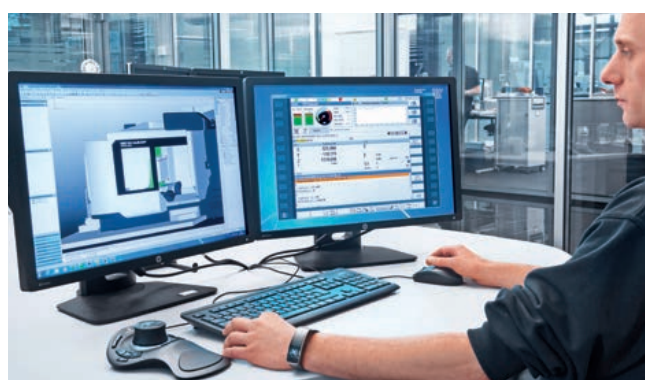
Die DMG MORI Virtual Machine ist ein 1:1-Abbild der DMC 160 H duoBLOCK® inklusive der tatsächlichen Steuerung.
