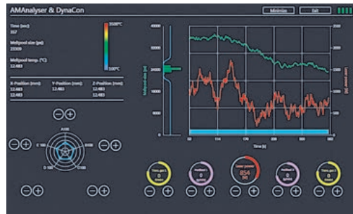
Adaptive Prozesskontrolle Automatische Anpassung der Laserleistung.
