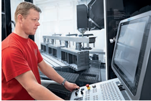
5-Achs-Simultanbearbeitung von Großbauteilen auf der DMU 340 P.
